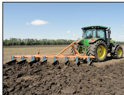
Плуг скоростной ПСК-8 в агрегате с трактором Джон Дир 8420 на отвальной вспашке почвы
