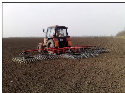
Борона легкая пружинная БЛП-9 в агрегате с трактором МТЗ-82
