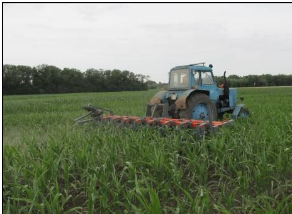
Рисунок 2 – Культиватор междурядной обработки КМО-5,6 в агрегате с трактором МТЗ-80 на междурядной культивации кукурузы
