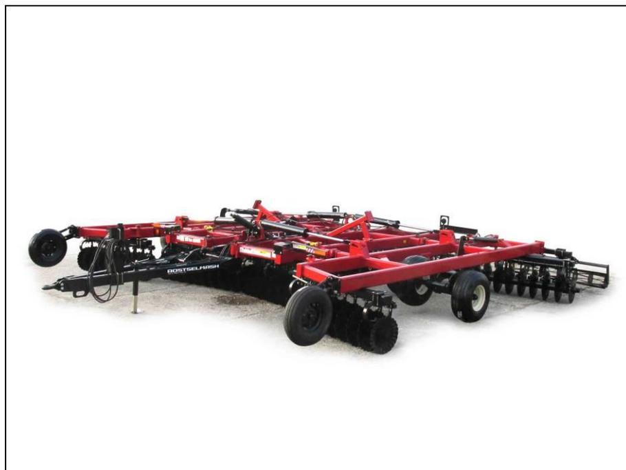
**Борона дисковая для вертикальной обработки почвы VVT-8,7**
