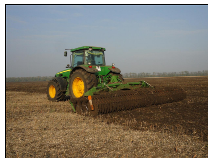
Борона дисковая Catros 6001-2 в агрегате с трактором Джон Дир 8420, на дисковом лущении стерни сои
