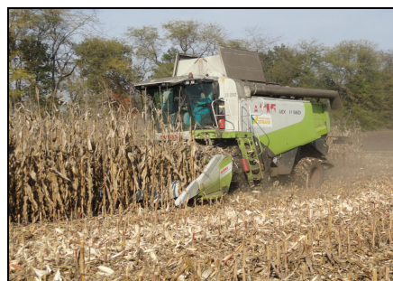
Приспособление для уборки кукурузы на зерно CONSPEED 8-70 с комбайном "LEXION 560" в работе
