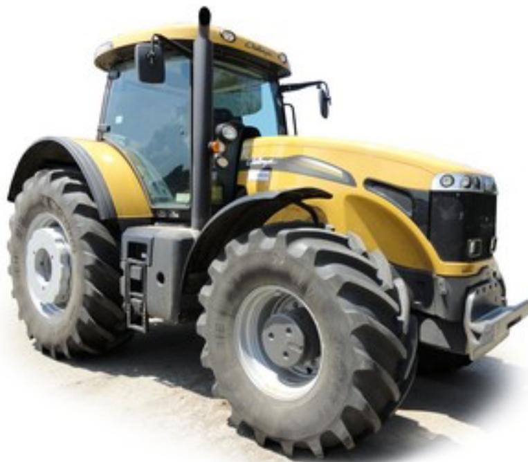
Колесный трактор Challenger модели MT-665C фирмы "Caterpillar Inc" с колесной формулой 4 ´ 4 предназначен для выполнения энергоемких операций в растениеводстве, кормопроизводстве и транспортных работах.
