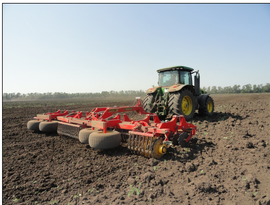
Рисунок 3 – Дисковый культиватор VADERSTAD CR 820 в агрегате трактором John Deere 8320R, на дисковом выравнивании пахоты
