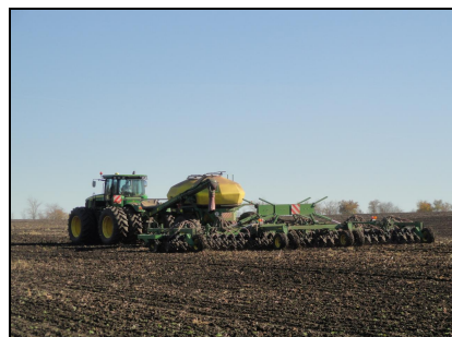
Посевной комплекс "John Deere 1890" в агрегате с трактором John Deere 9460R на посеве озимой пшеницы
