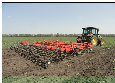
Трактор John Deere 8295R в агрегате с культиватором KUNN мод. 5635, на сплошной культивации
