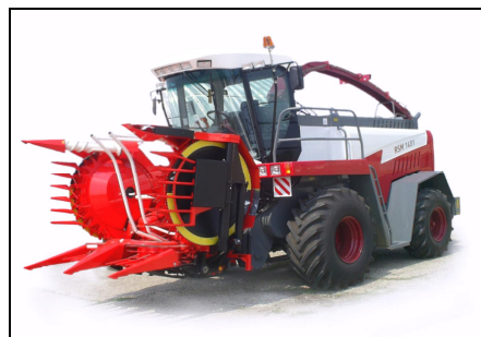
Общий вид комбайна РСМ-1401 в агрегате с приспособлением Kemper 445, в транспортном положении
