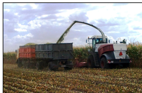
Общий вид комбайна РСМ-1401 в агрегате с приспособлением Kemper 445, в работе
