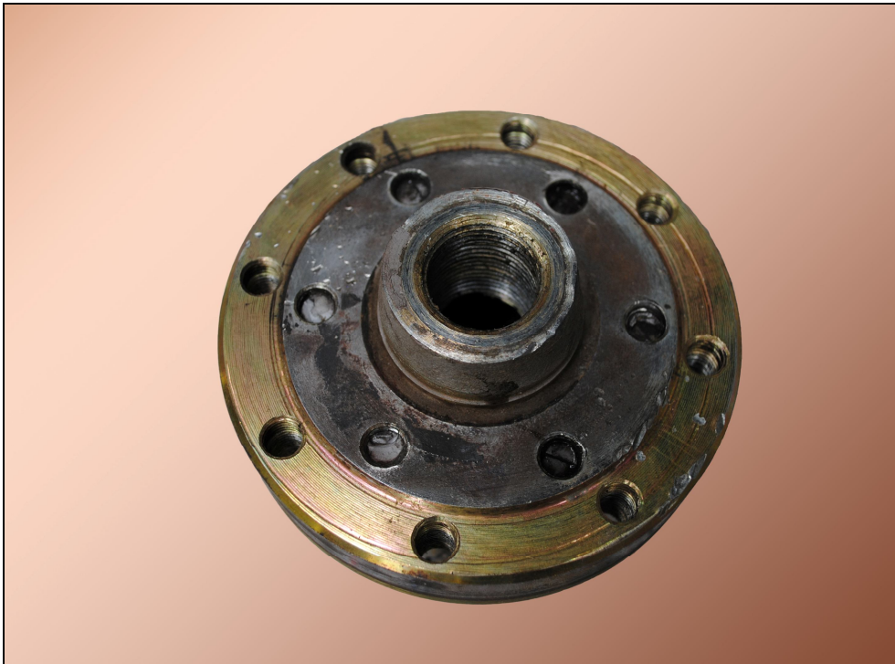
Рисунок А.1 – Срез болтов ведущего шкива привода вентилятора моторной установки
