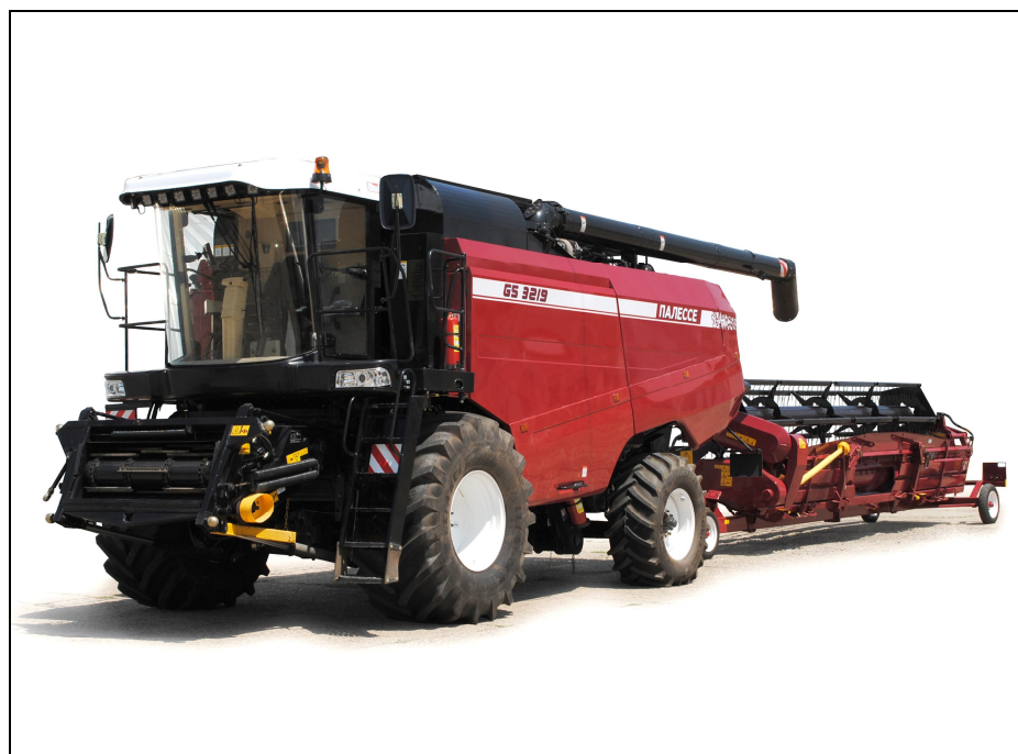
Рисунок 4 – Комбайн зерноуборочный КЗС-3219КР в агрегате с тележкой и установленной на ней жаткой ЖЗК-7-5, вид спереди слева
