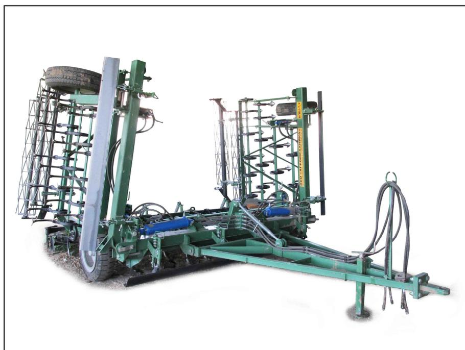
**Культиватор полуприцепной широкозахватный КПШ-7,2**
