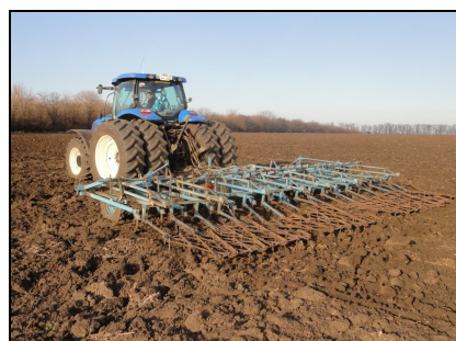
Трактор New Holland T7060 в агрегате с культиватором КПК-8Б на сплошной культивации
