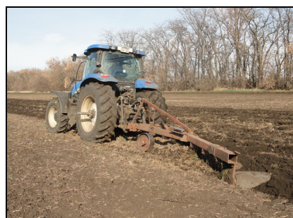
Трактор New Holland T7060 в агрегате с плугом ПЛН-6х35 на вспашке
