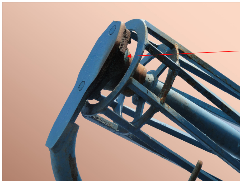
Рисунок А.1 – Срез пресс-масленки на опоре катка
