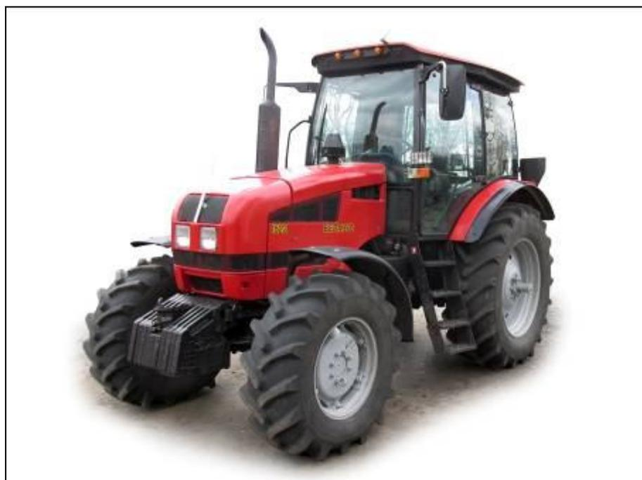
Рисунок 1 – Трактор модели Беларус 1523, общий вид
