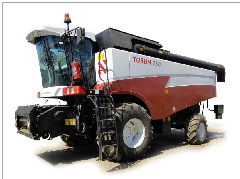
Рисунок 1 – Комбайн зерноуборочный самоходный PCM-181 "Torum-750", общий вид
