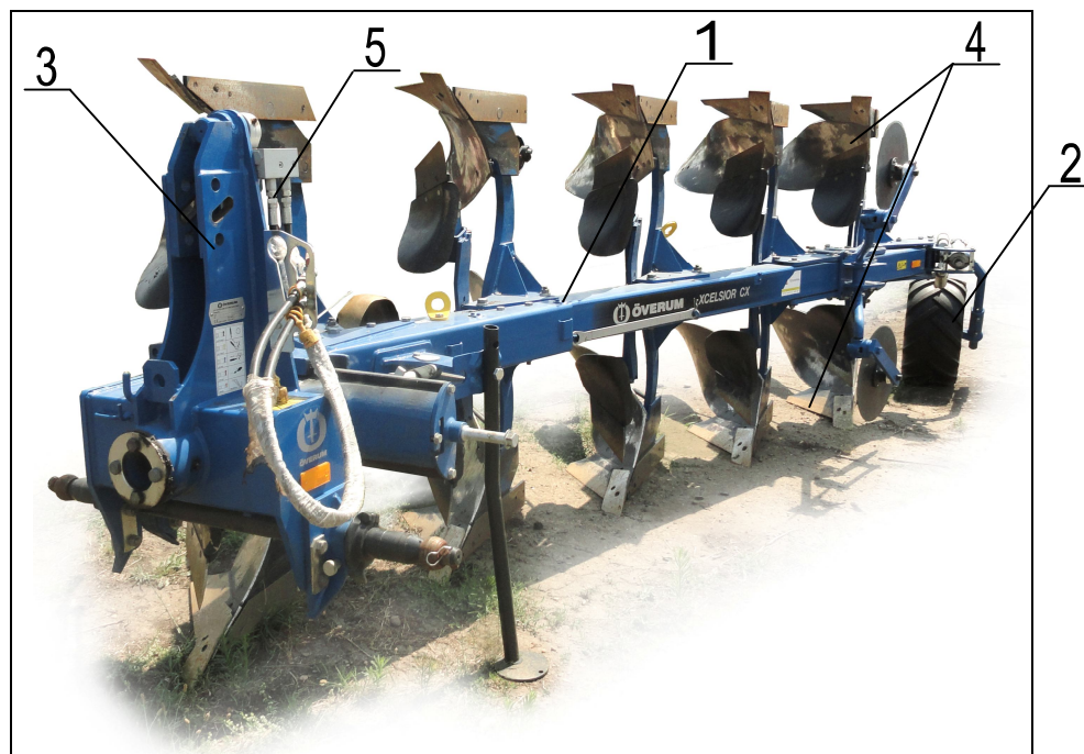
Рисунок 1 – Плуг ÖVERUM CX 5975 F XL, вид спереди слева: 1 - рама; 2 - опорное колесо; 3 - навесное устройство; 4 - рабочие органы; 5 - гидросистема
