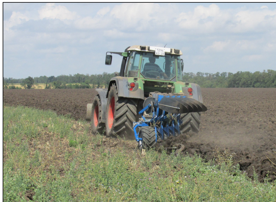
Рисунок 2 – Плуг ÖVERUM CX 5975 F XL в агрегате с трактором Fendt 716, на отвальной вспашке почвы (фон 1)
