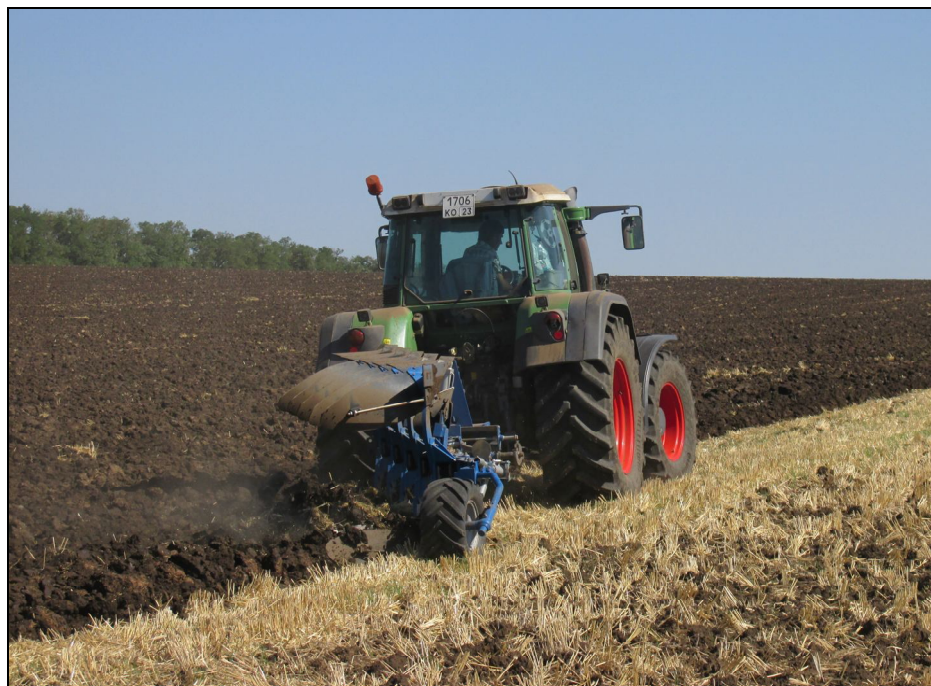
Рисунок 3 – Плуг ÖVERUM CX 5975 F XL в агрегате с трактором Fendt 716, на отвальной вспашке почвы (фон 2)
