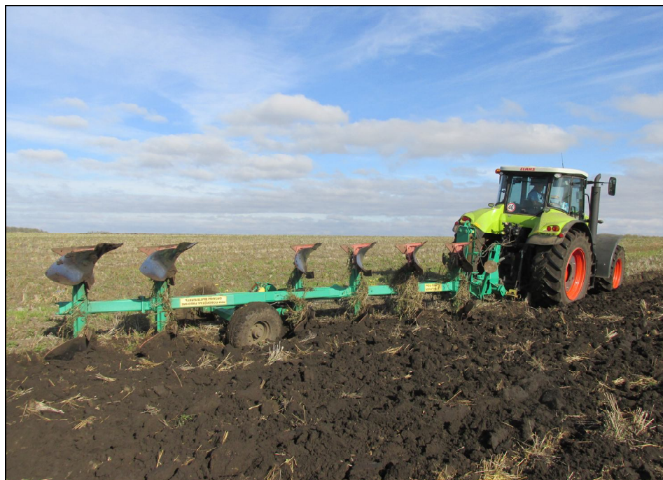
Рисунок 1 – Плуг полунавесной оборотный ППО-6-40-01 в агрегате с трактором CLAAS AXION 820, на отвальной вспашке почвы после дискового лущения стерни озимой пшеницы (1-й след)
