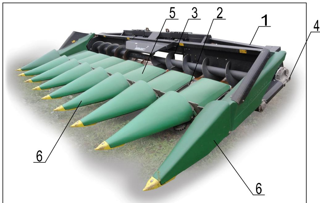
Рисунок 1 – Приспособление для уборки кукурузы Geringhoff RD 800/В, вид спереди слева:
