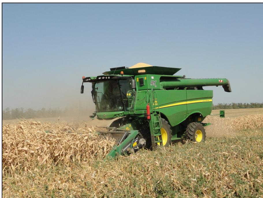
Рисунок 2 – Приспособление Geringhoff RD 800/В в агрегате с комбайном зерноуборочным JOHN DEERE S660 на уборке кукурузы на зерно
