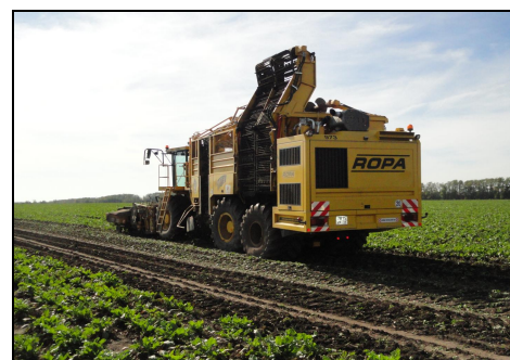
Комбайн свеклоуборочный самоходный Ропа euro-Tiger V8-3, в работе
