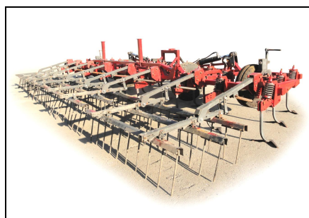
Культиватор прицепной комбинированный КПК-8Б в рабочем положении, вид сзади справа
