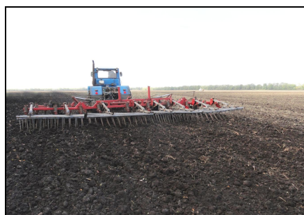
Культиватор КПК-8Б в агрегате с трактором Т-150К на обработке почвы после дискового лущения стерни сои
