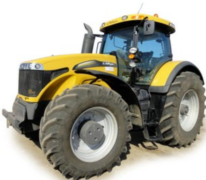
Колесный трактор Challenger модели MT-685D фирмы "Caterpillar Inc" с колесной формулой 4´4 предназначен для выполнения энергоемких операций в растениеводстве, кормопроизводстве и транспортных работах.
