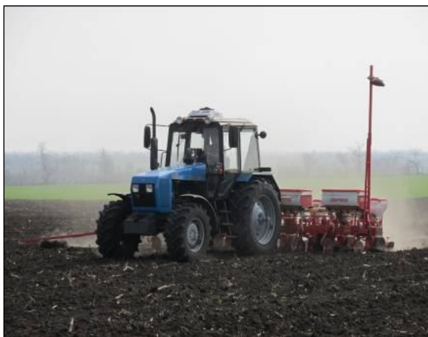
Рисунок 5 – Сеялка пропашная пневматическая точного высева Gaspardo MTR 8R, в агрегате с трактором Беларус 1221.2, на посеве семян кукурузы
