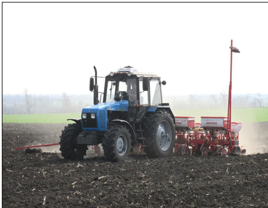
Рисунок 2 – Трактор Беларус 1221.2 в агрегате с сеялкой пропашной пневматической точного высева Gaspardo MTR 8R на посеве семян с кукурузы
