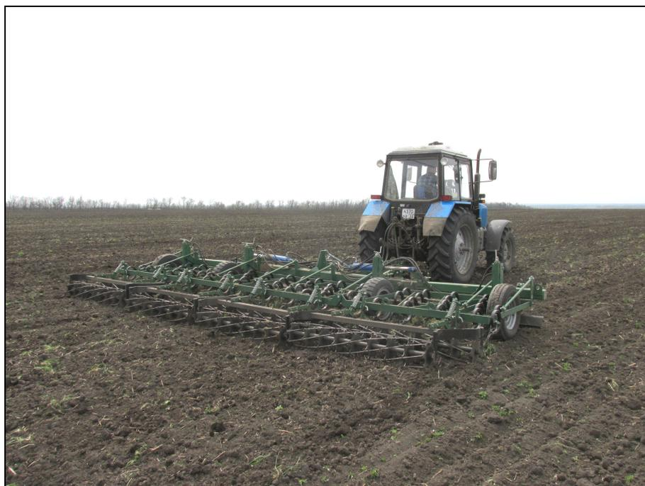
Рисунок 3 – Трактор Беларус 1221.2 в агрегате с культиватором полуприцепным широкозахватным КПШ-7,2 на сплошной культивации почвы
