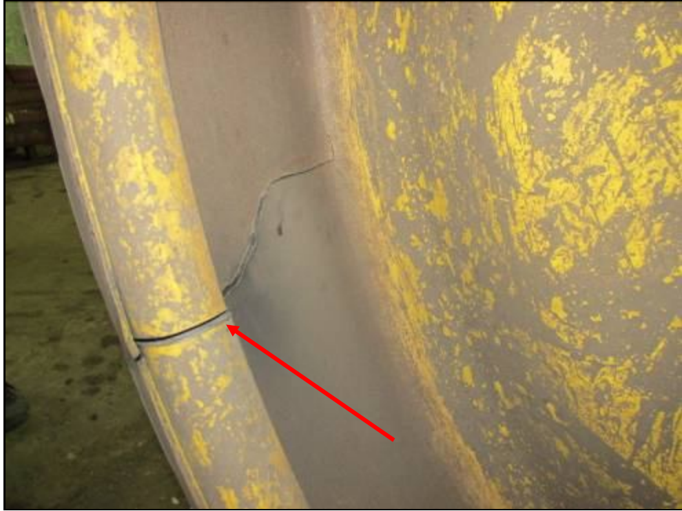
Рисунок А.1 – Трещина ведущего колеса
