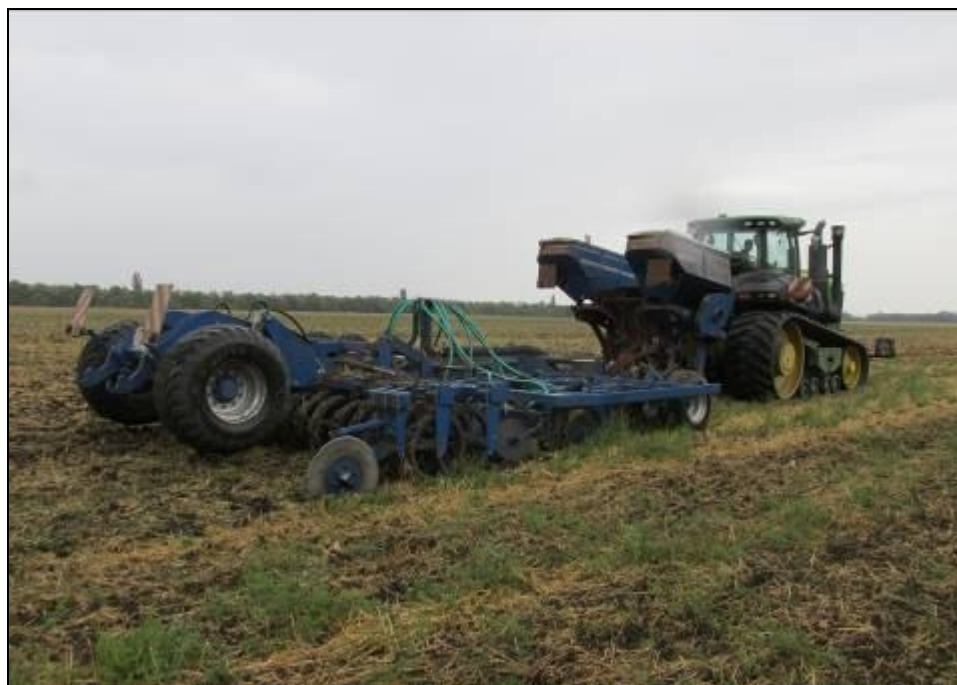
Рисунок 4 – Трактор John Deere 9520 RT в агрегате с агрегатом комбинированным Кöscherling Master 5.4/6.2 на комбинированной обработке почвы с внесением минеральных удобрений
