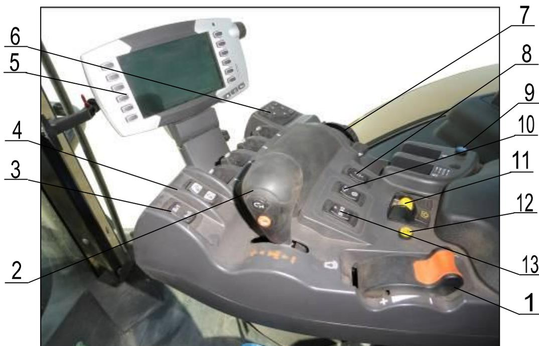
Рисунок 4 – Центр управления трактора (ТМС):
