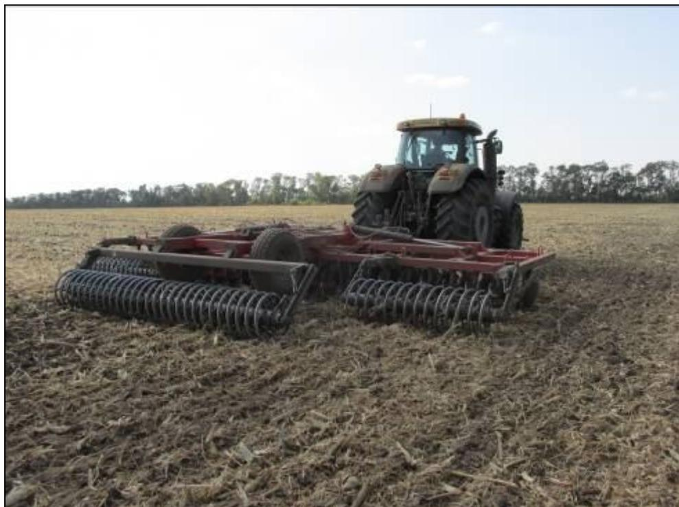
Рисунок 9 – Трактор Challenger MT 685 D в агрегате с бороной дисковой БДМ-7х3ПК, на дисковом лущении стерни кукурузы (2-й след)
