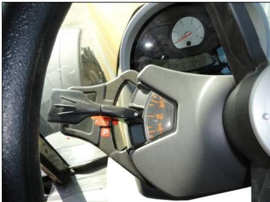
Рисунок 5 – Управление сервоприводом переключения направления движения Power Shuttle и электрогидравлический тормоз Park Lock
