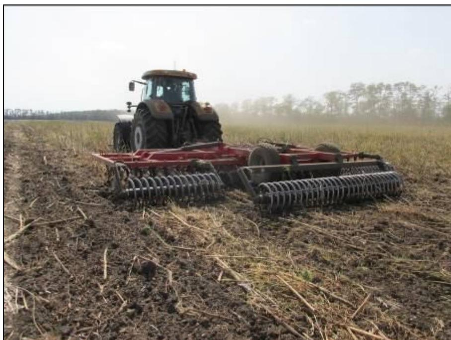
Рисунок 8 – Трактор Challenger MT 685 D в агрегате с бороной дисковой БДМ-7х3ПК, на дисковом лушении стерни подсолнечника (1-й след)
