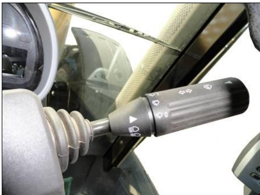
Рисунок 6 – Многофункциональный подрулевой переключатель (используется для включения указателей поворота, очистителей ветрового стекла, омывателей заднего и ветрового стекел и звукового сигнала)
