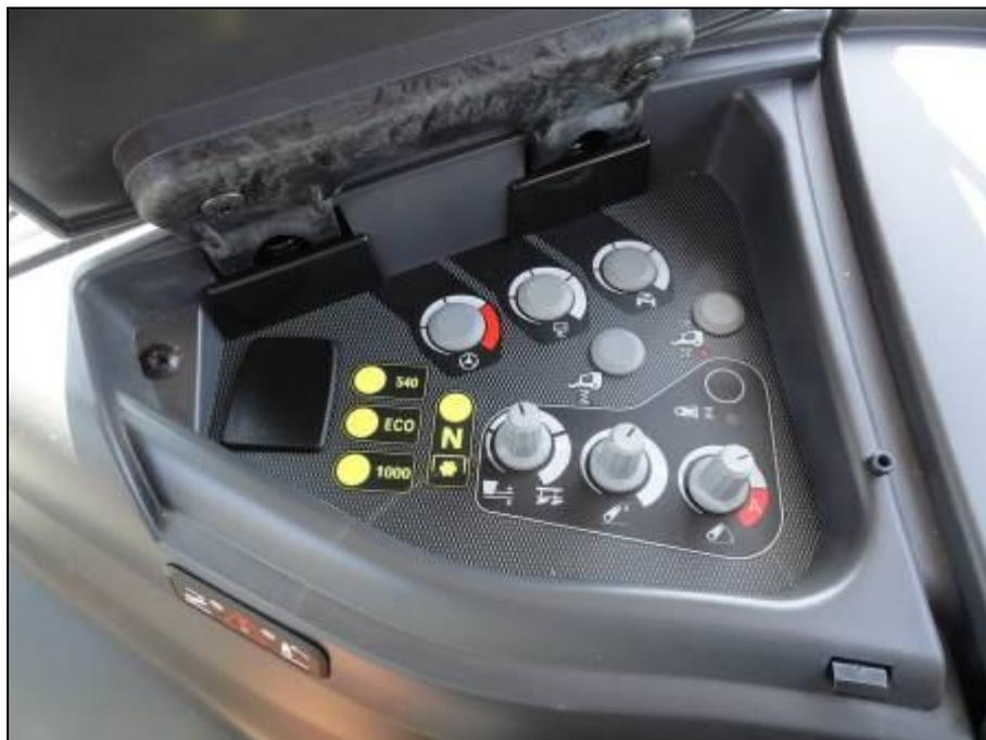
Рисунок 7 – Блок управления механизмом отбора мощности и заднего навесного устройства
