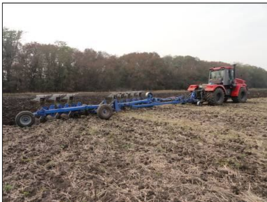
Рисунок 2 – Трактор "Кировец" К-744Р3 в агрегате с плугом ППО-8x40П на отвальной вспашке почвы
