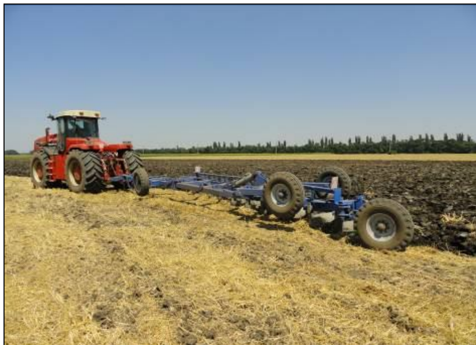
Рисунок 4 – Трактор колесный Versatile 2375 в агрегате с плугом ПП-(9+2)×35ЕП, на отвальной вспашке почвы после уборки озимой пшеницы
