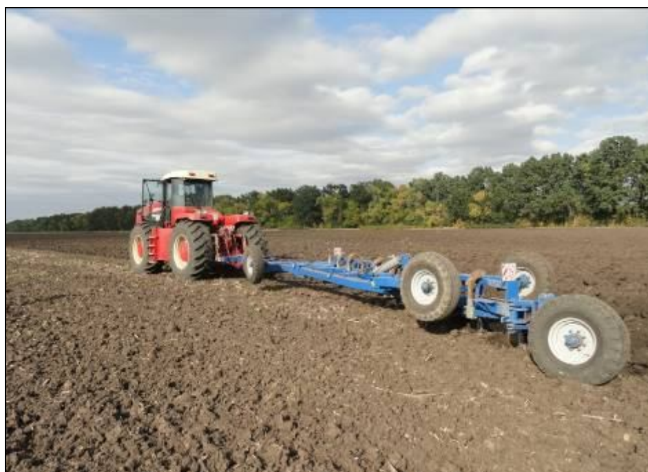
Рисунок 6 – Трактор колесный Versatile 2375 в агрегате с плугом ПП-(9+2)×35ЕП, на отвальной вспашке почвы после дискового лущения стерни озимой пшеницы (2 след)
