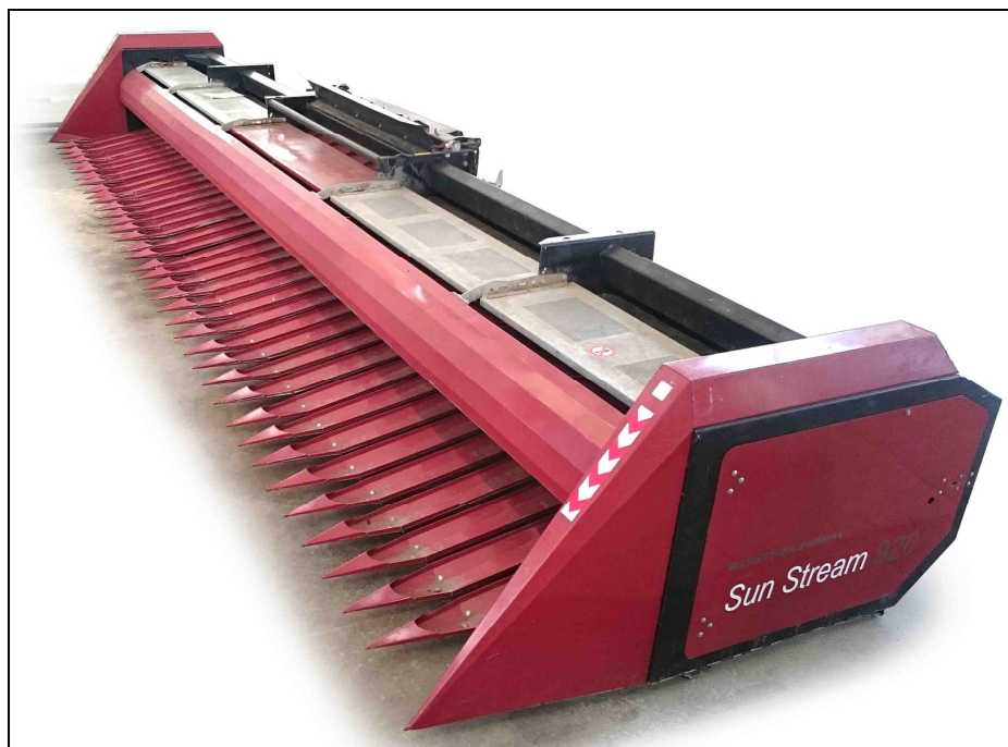
Жатка сплошного среза для уборки подсолнечника RSM SS-920
