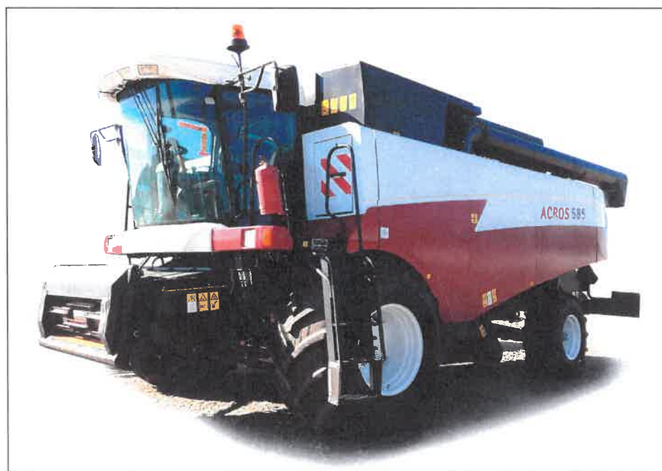
Рисунок 1 – Комбайн зерноуборочный самоходный PCM-142 "ACROS-585", общий вид
