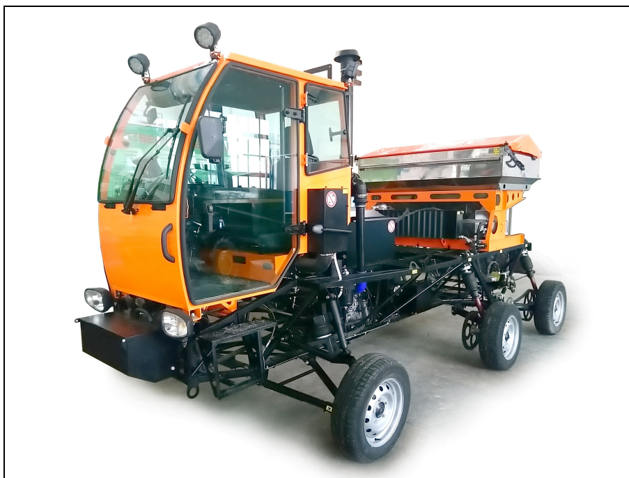
Рисунок 1 – Опрыскиватель-разбрасыватель самоходный Туман-1М комплектуемый сменным технологическим оборудованием (разбрасывателем Туман-1М), вид спереди слева
