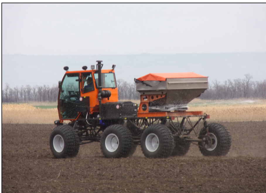
Рисунок 3 – Опрыскиватель-разбрасыватель самоходный Туман-1М комплектуемый сменным технологическим оборудованием (разбрасывателем Туман-1М), на внесении аммиачной селитры под посев сахарной свеклы
