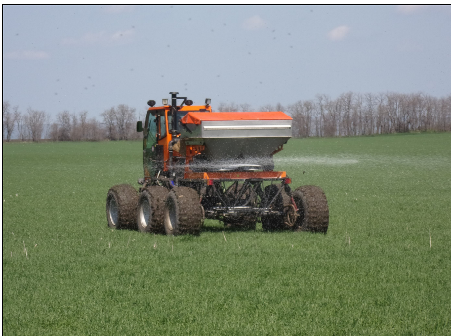
Рисунок 2 – Опрыскиватель-разбрасыватель самоходный Туман-1М комплектуемый сменным технологическим оборудованием (разбрасывателем Туман-1М), на внесении аммиачной селитры по озимой пшенице
