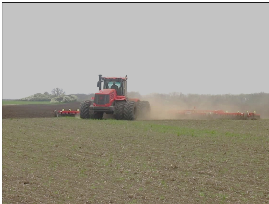
Рисунок 2 – Средний предпосевной культиватор "Tillermaster-18000" в агрегате с трактором К-744 Р4, на предпосевной сплошной культивации
