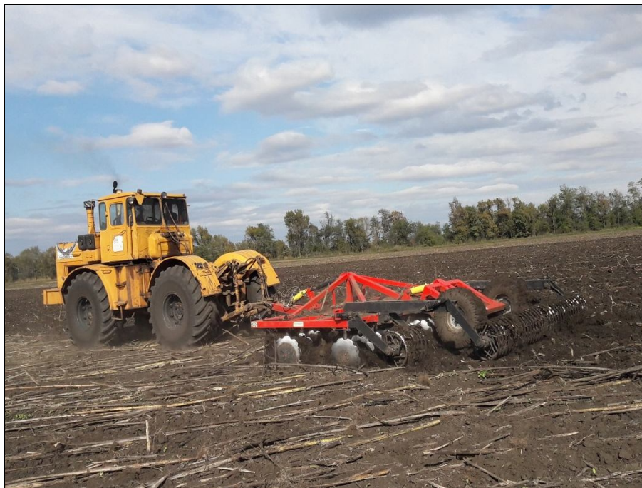
Рисунок 3 – Борона дисковая (Дискатор) БДМ 6×4П в агрегате с трактором К-701 на дисковом лушении пожнивных остатков подсолнечника (2 след)
