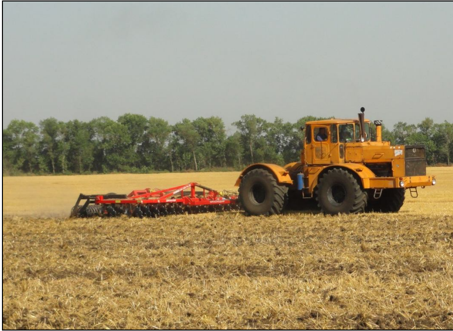
Рисунок 2 – Борона дисковая (Дискатор) БДМ 6×4П в агрегате с трактором К-701 на дисковом лушении стерни озимой пшеницы (1 след)
