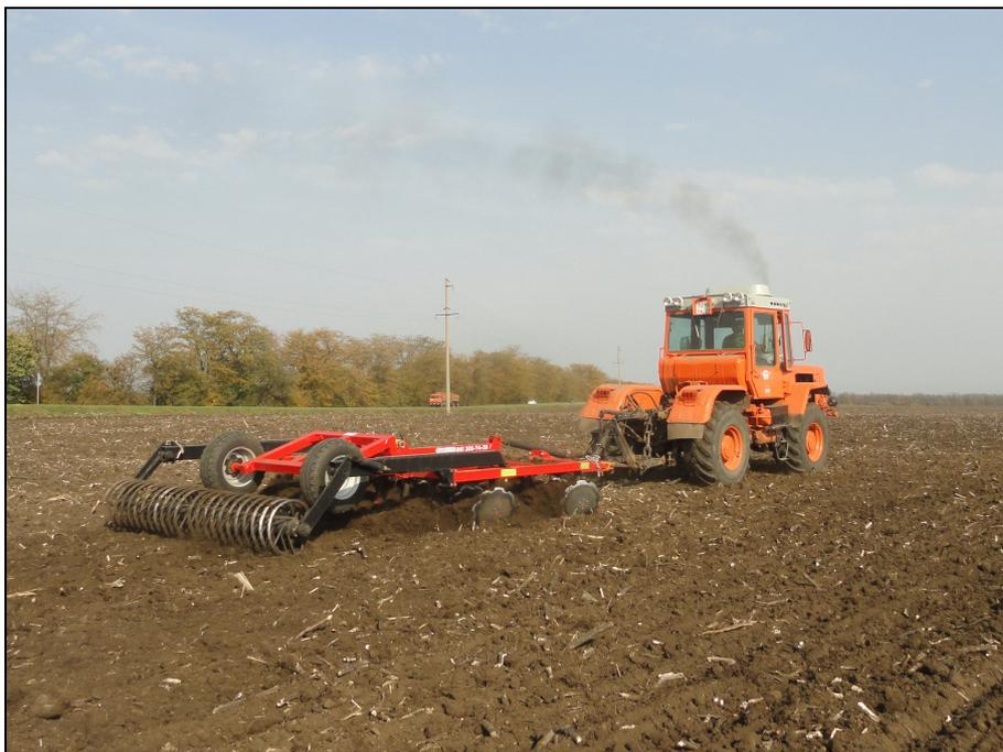
Рисунок 3 – Борона дисковая (Дискатор) БДМ 2,8×4П в агрегате с трактором Т-151К на дисковом лушении пожнивных остатков подсолнечника (2 след)
