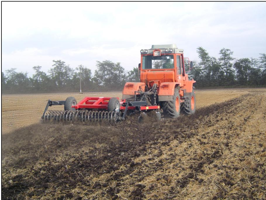
Рисунок 2 – Борона дисковая (Дискатор) БДМ 2,8×4П в агрегате с трактором Т-151К на дисковом лушении стерни озимой пшеницы (1 след)
