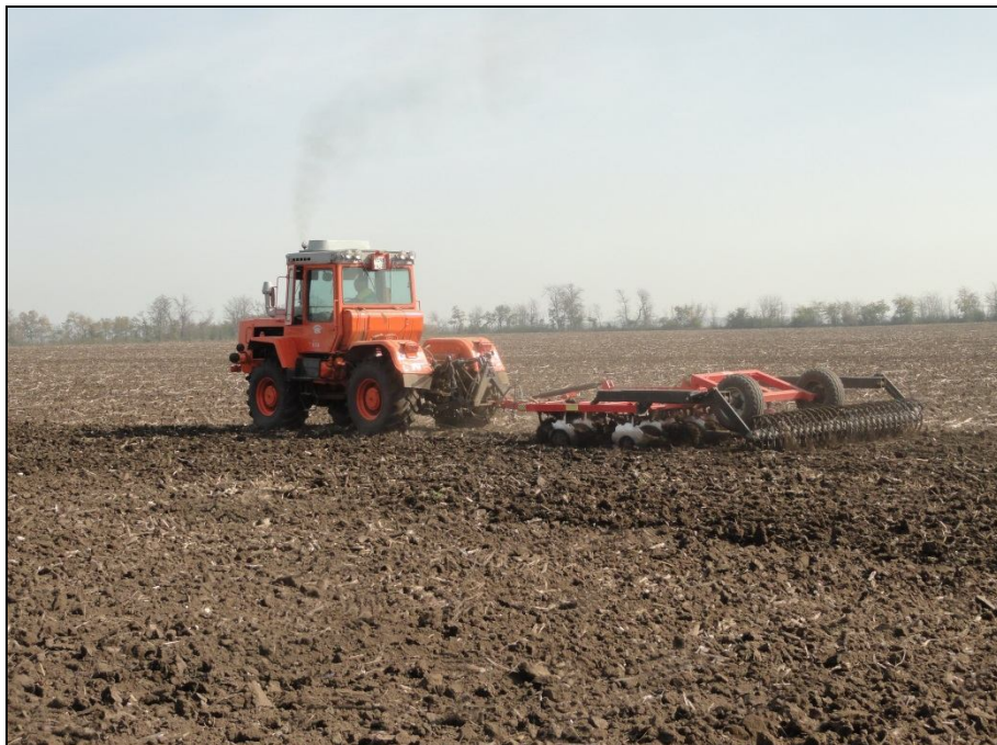
Рисунок 3 – Борона дисковая (Дискатор) БДМ 3×4П в агрегате с трактором Т-151К, на дисковом лущении пожнивных остатков подсолнечника (2 след)
