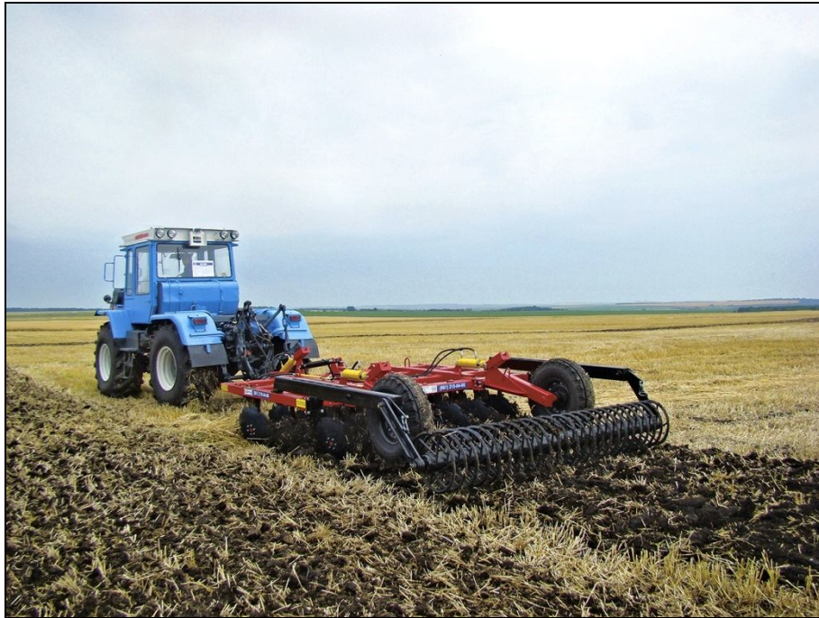
Рисунок 2 – Борона дисковая (Дискатор) БДМ 3×4П в агрегате с трактором ХТЗ-17021, на дисковом лущении стерни озимого ячменя (1 след)
