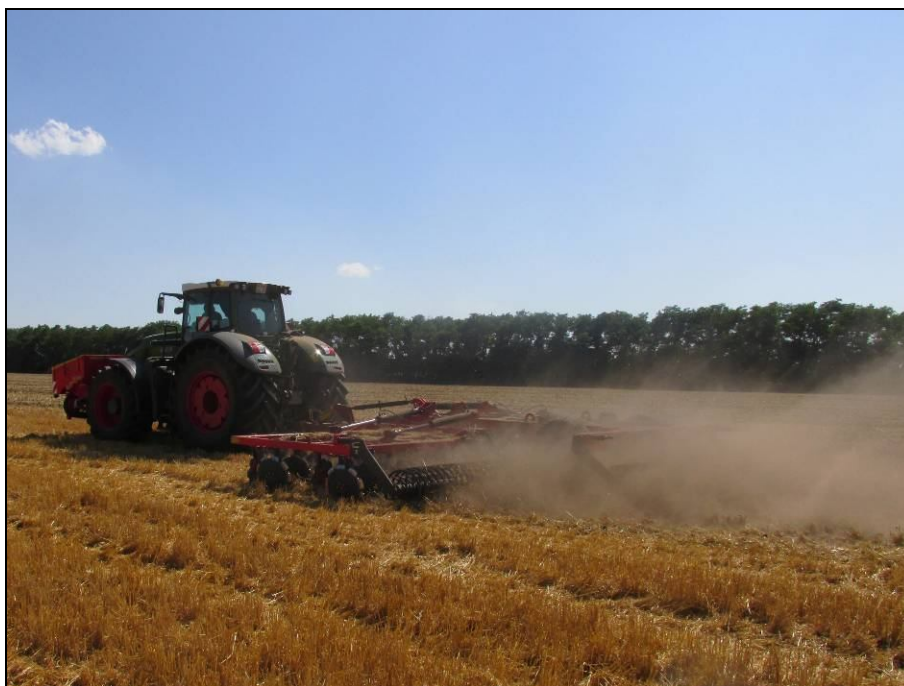
Рисунок 2 – Борона дисковая (Дискатор) БДМ 9×4П в агрегате с трактором Fendt 1050 Varіo на дисковом лушении стерни озимой пшеницы (1 след)
