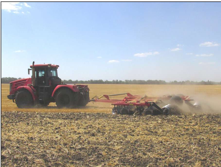
Рисунок 2 – Борона дисковая (Дискатор) БДМ 8×4П в агрегате с трактором К-744 Р4, на дисковом лущении стерни озимой пшеницы (1 след)
