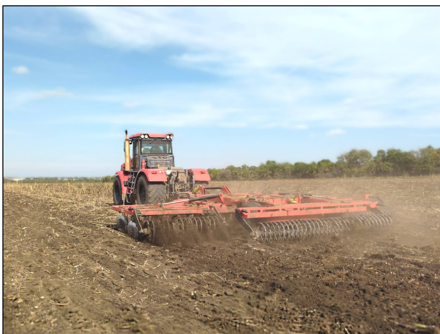
Рисунок 3 – Борона дисковая (Дискатор) БДМ 8×4П в агрегате с трактором К-744 Р4, на дисковом лущении пожнивных остатков подсолнечника (1 след)
