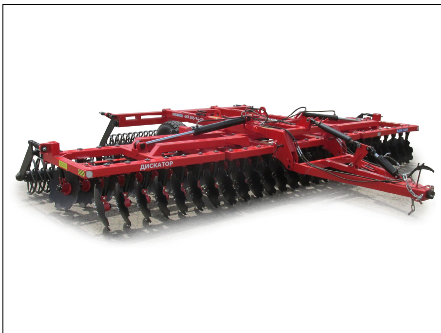
Рисунок 1 – Борона дисковая (Дискатор) БДМ 7×2П, вид спереди справа
