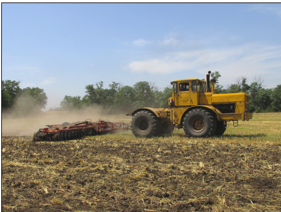
Рисунок 2 – Борона дисковая (Дискатор) БДМ 7×2П в агрегате с трактором К-700 на дисковом лушении стерни озимого ячменя (1 след)
