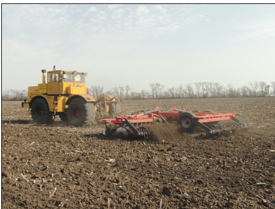
Рисунок 3 – Борона дисковая (Дискатор) БДМ 7×2П в агрегате с трактором К-700 на дисковом лушении пожнивных остатков подсолнечника (2 след)
