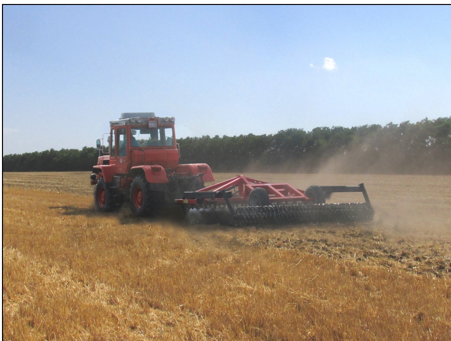
Рисунок 2 – Борона дисковая (Дискатор) БДМ 4×2П в агрегате с трактором Т-151К на дисковом лушении стерни озимого ячменя (1 след)
