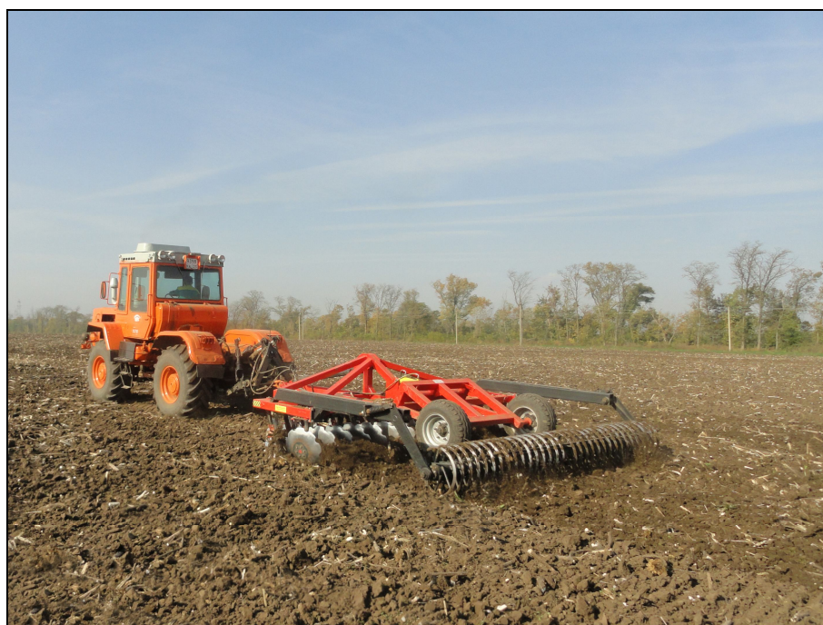
Рисунок 3 – Борона дисковая (Дискатор) БДМ 4×2П в агрегате с трактором Т-151К на дисковом лушении пожнивных остатков подсолнечника (2 след)
