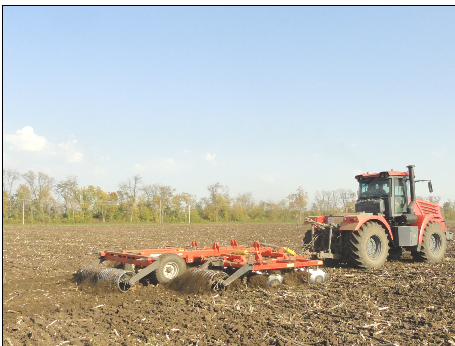
Рисунок 3 – Борона дисковая (Дискатор) БДМ 6,6×4ПК в агрегате с трактором К-744 РЗ на дисковом лущении пожнивных остатков подсолнечника (2 след)
