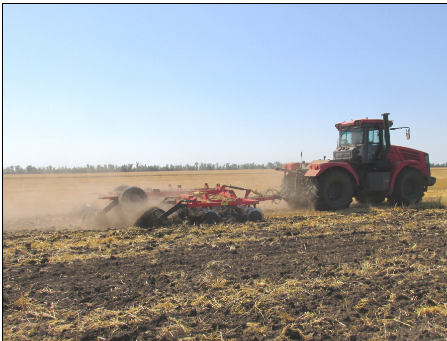
Рисунок 2 – Борона дисковая (Дискатор) БДМ 6,6×4ПК в агрегате с трактором К-744 РЗ на дисковом лущении стерни озимого ячменя (1 след)
