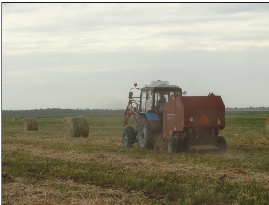
Рисунок 2 – Пресс-подборщик рулонный ППР-150 "Pelikan Max" в агрегате с трактором МТЗ-82 на подборе и прессовании валков сена в рулоны с обмоткой их шпагатом
