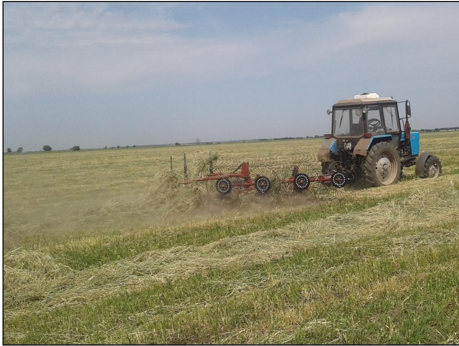
Рисунок 2 – Грабли колесно-пальцевые ГКП-600-01 "Kolibri V Plus" в агрегате с трактором МТЗ-82 на сгребании трав из прокосов в валки, оборачивание и ворошение валков сена
