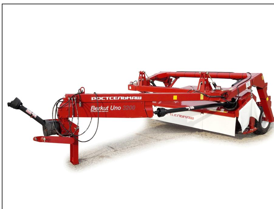
Рисунок 1 – Косилка роторная полуприцепная
