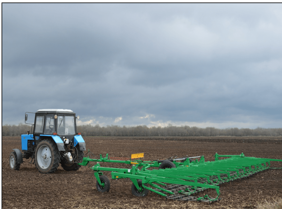
Рисунок 2 – Борона широкозахватная гидрофицированная БШГ -12-К1 "Пустельга" в агрегате с трактором МТЗ-1221 на разрушении почвенной корки перед посевом озимых
