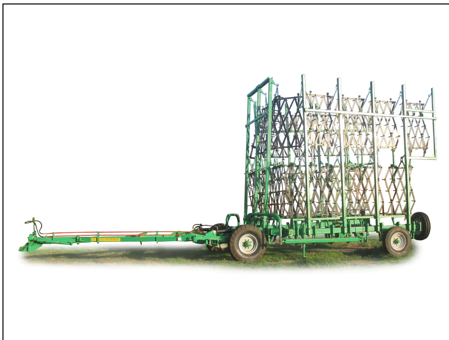
Рисунок 1 – Борона широкозахватная гидрофицированная БШГ -12-К1 "Пустельга", в транспортном положении
