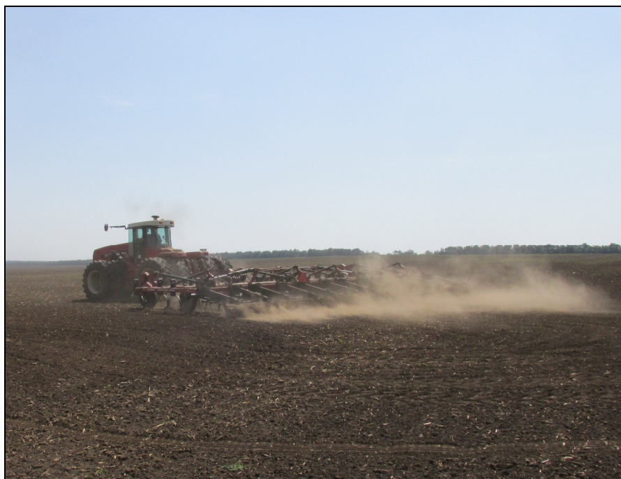
Рисунок 2 – Культиватор К-12200 в агрегате с трактором Versatile 2375 на сплошной культивации
