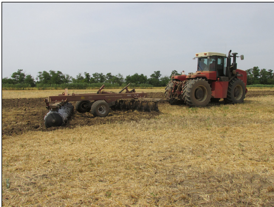
Рисунок 2 – Борона офсетная DV-1500/430 в агрегате с трактором Versatile-2375 на дисковом лущении стерни озимой пшеницы (1 след)
