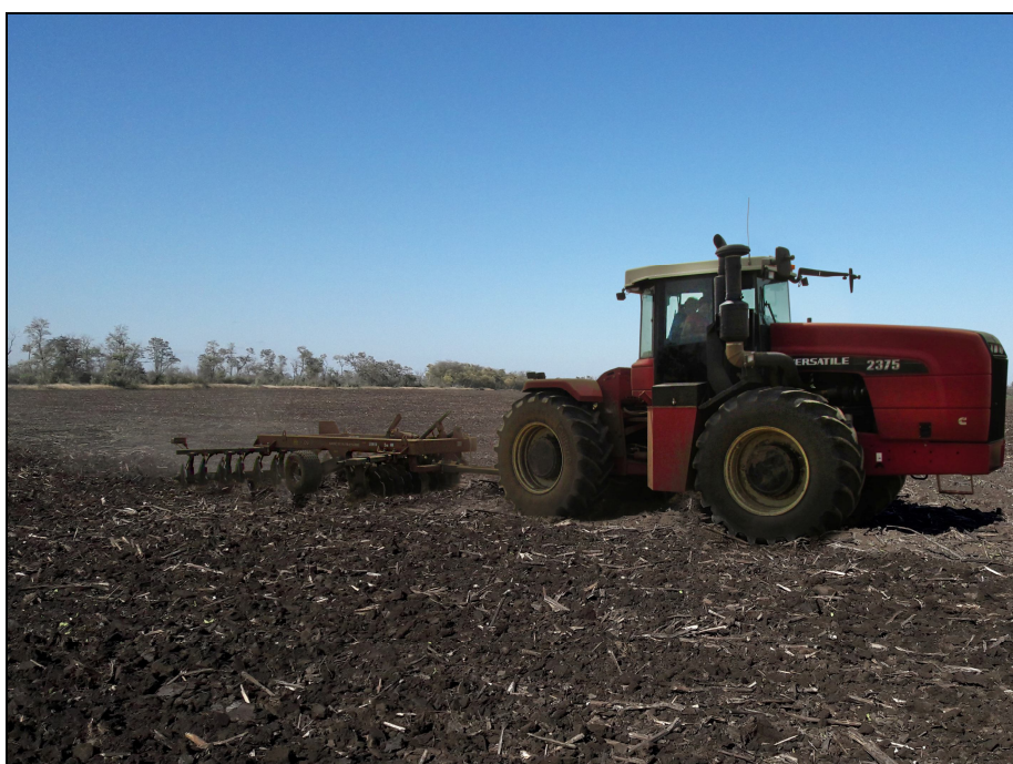
Рисунок 3 – Борона офсетная DV-1500/430 в агрегате с трактором Versatile-2375 на дисковом лущении пожнивных остатков подсолнечника(1 след)
