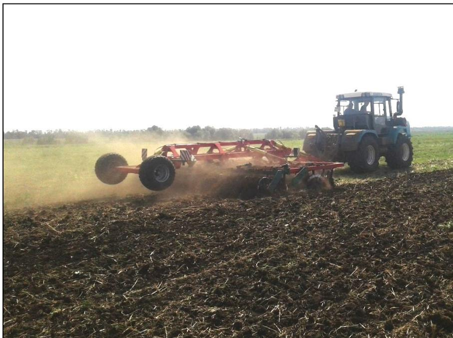
Рисунок 2 – Борона дисковая модернизированная марки "Диас" БДМ-6×3-Б-ПК-Д-ШКС в агрегате с трактором БТЗ-243К на дисковом лущении стерни озимого ячменя (2 след)
