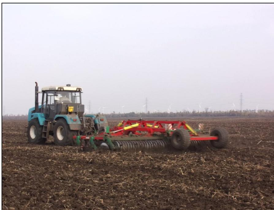
Рисунок 3 – Борона дисковая модернизированная марки "Диас" БДМ-6×3-Б-ПК-Д-ШКС в агрегате с трактором БТЗ-243К на дисковом лущении пожнивных остатков подсолнечника (2 след)
