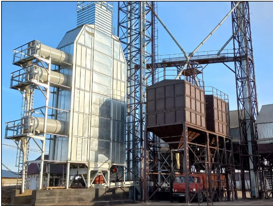
Рисунок 2 – Зерносушилка модульная жалюзийная FLATUM 6-8, в работе (на сушке зерна подсолнечника)
