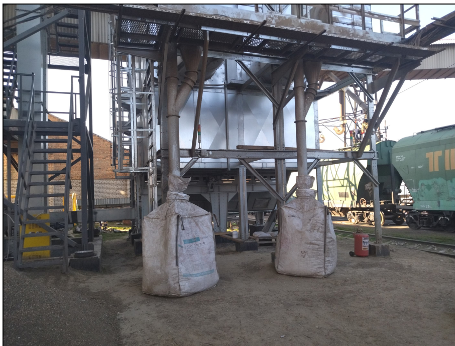
Рисунок 2 – Зерносушилка модульная жалюзийная FLATUM 5-12, в работе (на сушке зерна подсолнечника)
